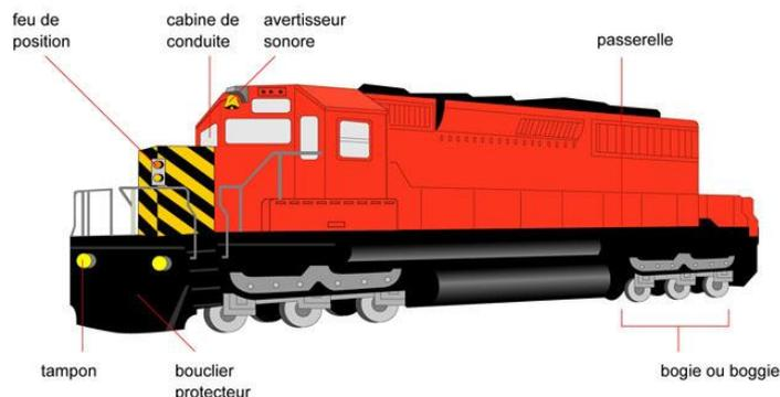
Véhicule ferroviaire muni d'un moteur et utilisé pour le remorquage de rames de voitures ou de wagons
