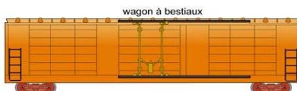
Wagon couvert, ventilé ou simplement ouvert à la partie supérieure des parois et utilisé pour le transport du bétail et autres animaux vivants.
