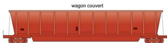
Wagon caractérisé par l'étanchéité de sa construction (parois sur toute la hauteur et toit) et par la sécurité du transport (wagon pouvant être fermé au cadenas ou plombé). Dans les wagons couverts sont inclus les wagons à toit ouvrant et les wagons isothermes, réfrigérants ou frigorifiques.
