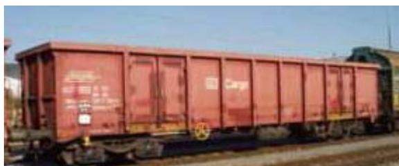
Véhicule ferroviaire normalement sans moteur et destiné au transport de marchandises. Les wagons servant pour le transport de passagers sont communément appelés « voitures »
