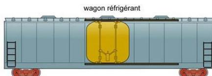
Wagon isotherme disposant d'une source de froid (glace hydrique, avec ou sans addition de sel; plaques eutectiques; glace carbonique, avec ou sans réglage de sublimation, gaz liquéfiés avec ou sans réglage d'évaporation, etc.) autre qu'un équipement mécanique ou à "absorption".
